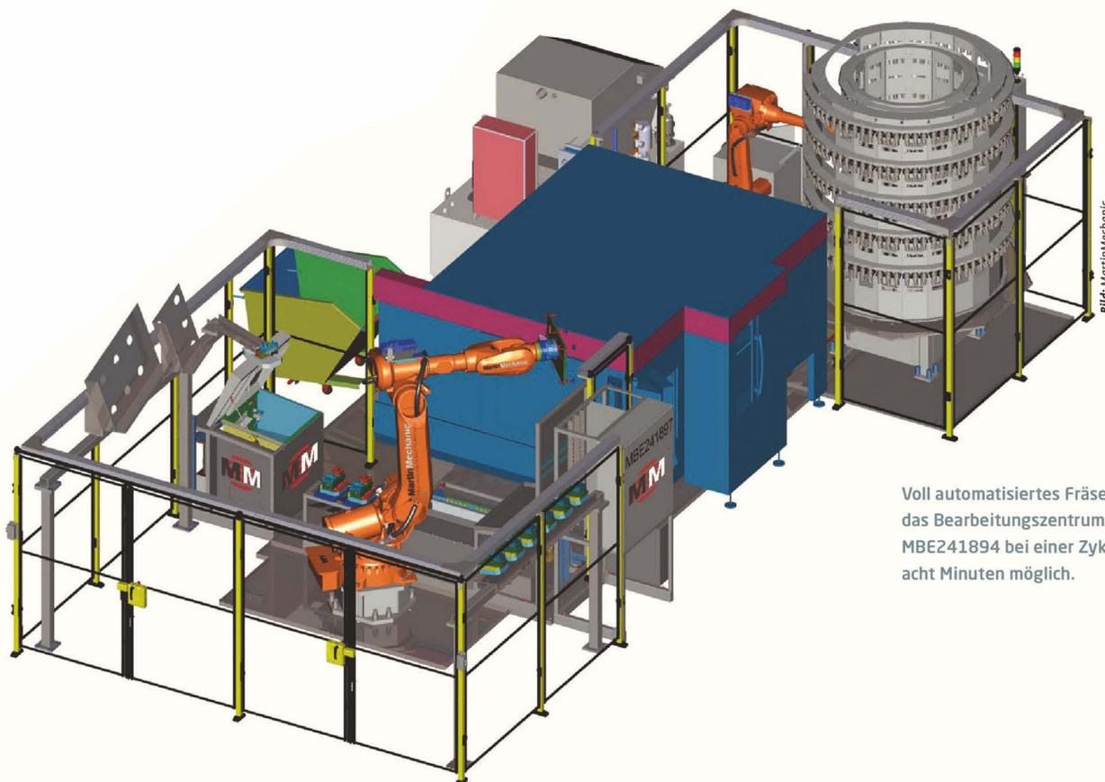
Voll automatisiertes Fräsen macht das Bearbeitungszentrum MBE241894 bei einer Zykluszeit von acht Minuten möglich.
